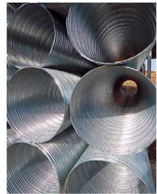
In Sötern werden kleine, mittlere und große Rohre gewickelt.
